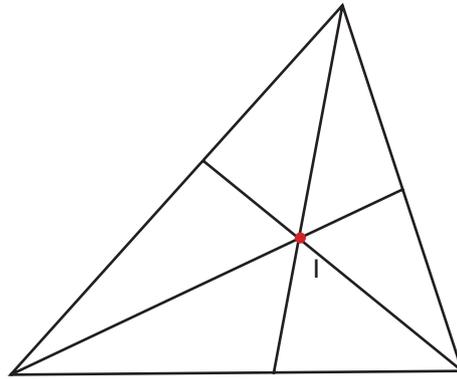
Figura 55 - Triângulo com as três bissetrizes e o ponto I, representando o incentro.
